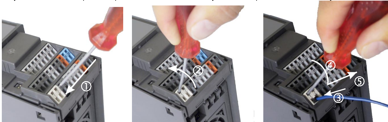
Obr. 21 Postup při upevnění vodiče v řídicí svorkovnici
